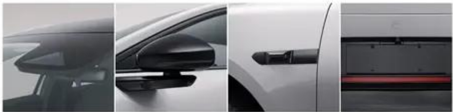
选装前单目摄像头 选装外后视镜单个摄像头 选装翼子板无摄像头 选装后保险杠单个摄像头
